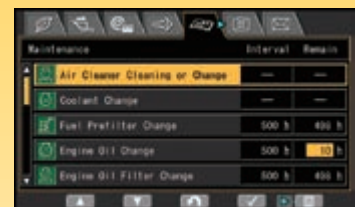
Écran de base de maintenance
