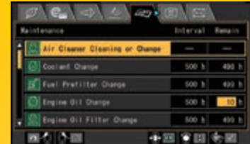
Écran de base de maintenance
