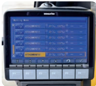
Contrôle des équipements intégré Komatsu (KIAC) offre jusqu'à 15 présélections d'outils pour le débit et la pression d'huile
