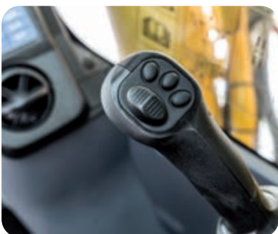
Commandes pratiques, ergonomiques et précises : leviers à bouton de commande proportionnel pour les accessoires
