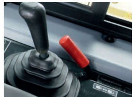
Levier de contrôle de la lame avec contrôle automatique de l'angle d'attaque et nouveau levier de contrôle du ripper avec relevage automatique du ripper
