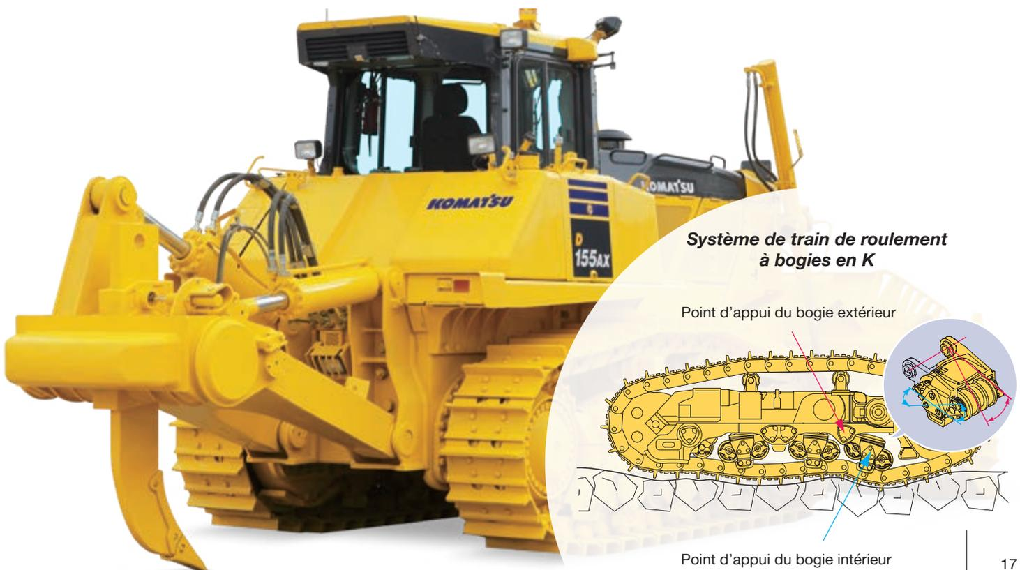
**Système de train de roulement à bogies en K**
