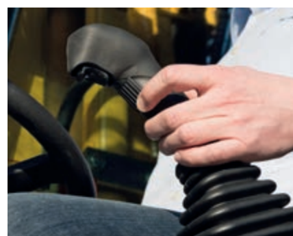
Pour les déplacements fréquents, le levier de direction réglable (en option) permet de contrôler la machine avec un effort moindre
