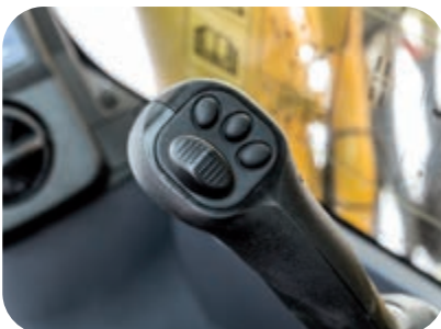
Commandes pratiques, ergonomiques et précises: leviers à bouton de commande proportionnel pour les accessoires
