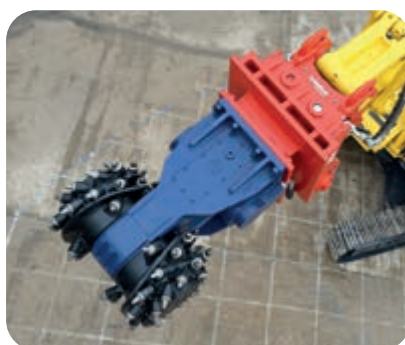
Deux circuits hydrauliques disponibles en option permettent d'utiliser une vaste gamme d'accessoires
