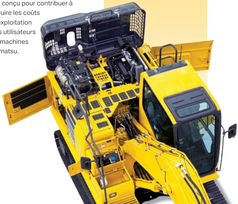
Pour faciliter l'accès au réservoir d'AdBlue®, celui-ci est installé sur l'escalier avant
