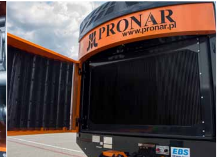
Système de nettoyage de radiateurs Cela permet de garder les refroidisseurs de moteur et l'huile hydraulique propres. Conçu pour travailler dans un environnement poussiéreux.
