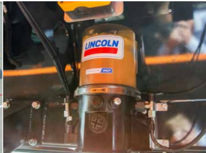
Système de graissage centralisé. Assure que chaque point est correctement lubrifié
