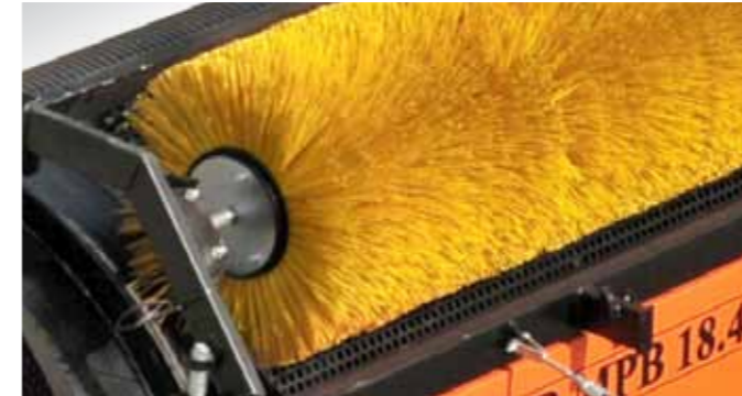
Brosse de nettoyage pilotée hydrauliquement
