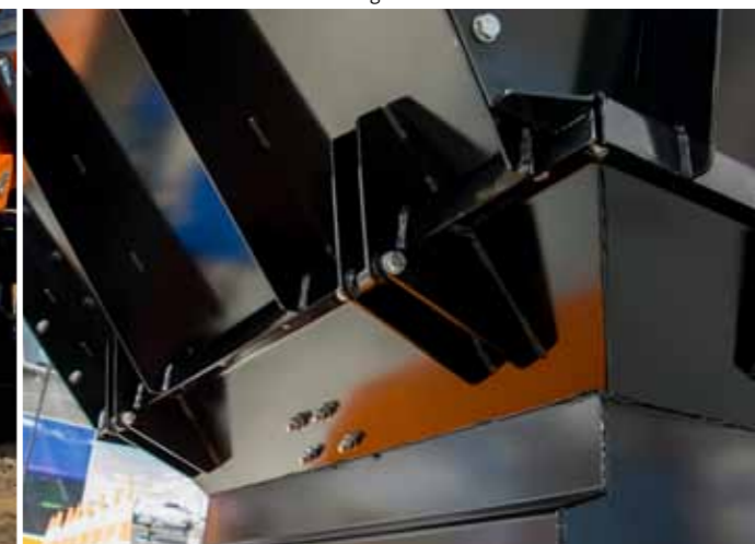
Parois inclinables de la trémie de charge directe
