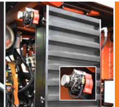
Le système Cleanfix va nettoyer les radiateurs du circuit moteur et/du circuit d'huile
