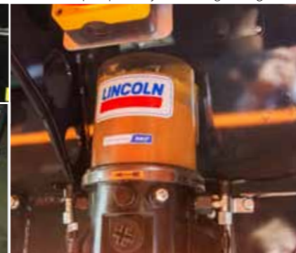
La pompe du système de graissage central assure une lubrification optimale
