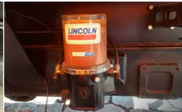
La pompe de graissage centralisée garantit une lubrification continue des éléments de la machine qui l'exigent (disponible en 2 formats)
