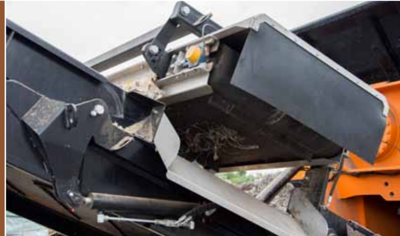
Overband ou séparateur magnétique alimenté hydrauliquement pour séparer les métaux
