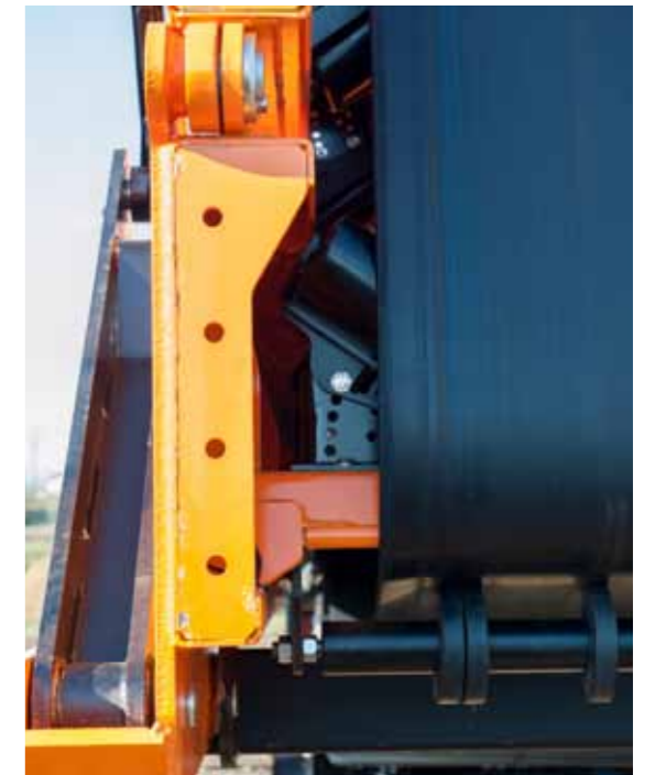
Possibilité de changer l'angle des rouleaux supportant la bande afin de former un flux de matériau transféré (changer le profil de la bande)
