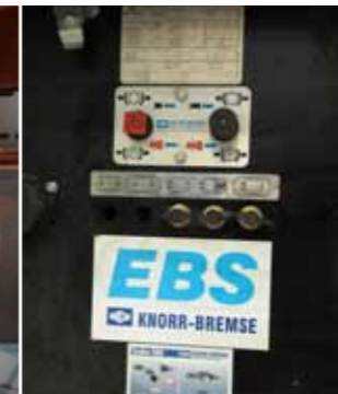
Système de freinage EBS et homologation permettant de circuler jusqu'à 100km/h sur la voie publique
