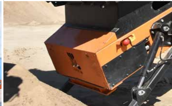
Le support à l'arrière du convoyeur protège les écrans des dommages lors de la pose de structures contre le sol (lorsque nous n'utilisons pas de pieds de support)
