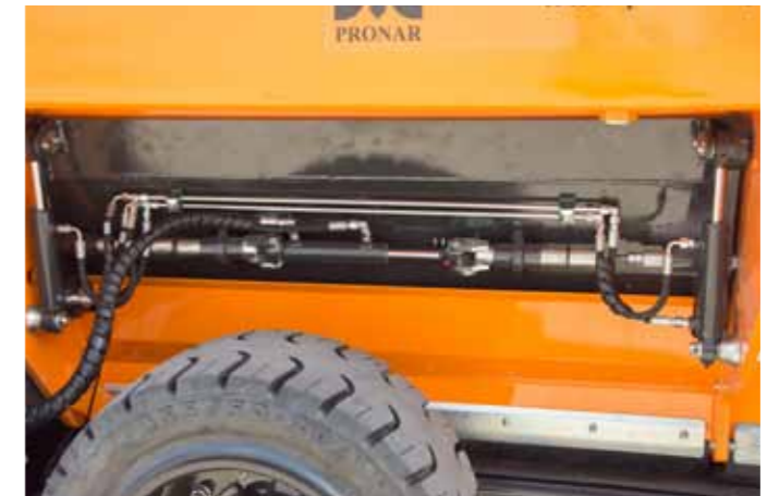
Peignes latéraux hydrauliques. Réglez la taille de la fraction de matériau broyé en quelques secondes sans aucun outil.
