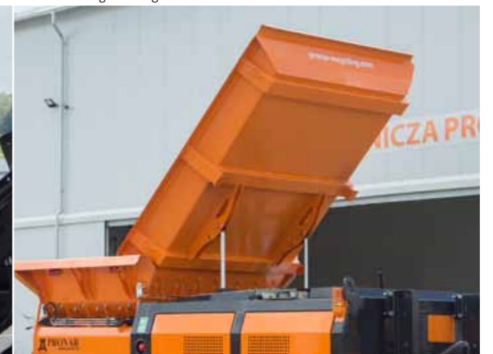
Goulotte relevée hydrauliquement. Chargez la machine avec encore plus de matériau avec un gros chargeur
