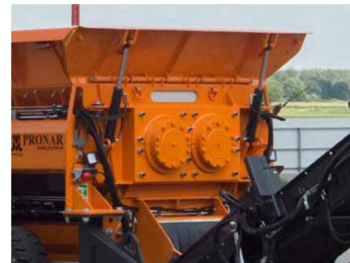
La cassette des rotors facile à retirer réduit considérablement le temps de commutation de la machine pour travailler avec différents matériaux
