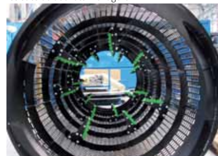
Couteaux internes aux tambours pour déchiqueter les sacs de déchets ménagers
