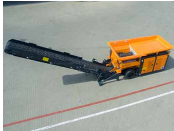
Le long convoyeur vous permet de faire de plus gros tas de matériaux sans avoir à déplacer la machine
