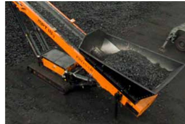
La grande durabilité du stockpiler permet l'utilisation d'une trémie à chargement direct d'une capacité de 8 m 3 sans aucune modification supplémentaire du stockpiler
