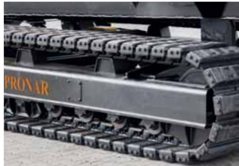
Les patins de chenilles en caoutchouc protègent le sol des égratignures causées par les portées en acier
