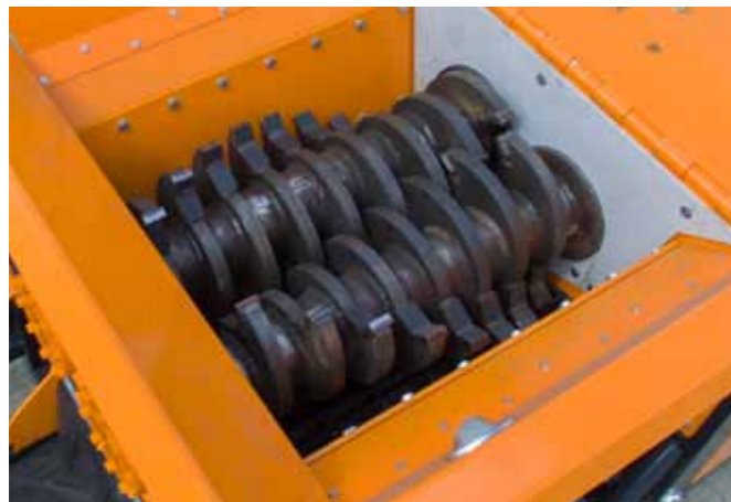
Chambre de broyage asynchrone. Les deux rotors fonctionnent à leur capacité maximale.
