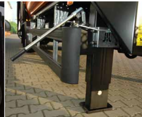
Pieds hydrauliques assure une stabilité accrue à la machine
