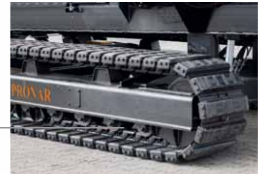
Le système hydraulique équipant le châssis de la machine MPB 20.55gh permet d'ajuster la hauteur et le niveau du crible pour faciliter le criblage et les déplacements sur terrains instables
