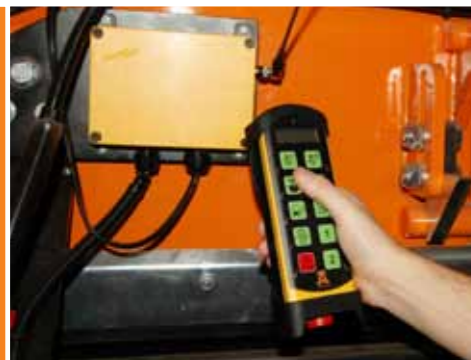
La radio télécommande permet de travailler confortablement à distance
