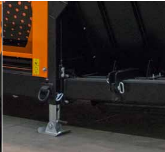
Les pieds de support avant mécaniques assurent la stabilité du trommel
