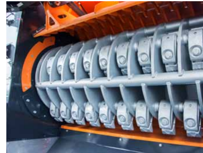
Rotor de déchiquetage Équipé de 36 couteaux, il tourne à 1000 tr / min. Il fonctionne très bien lors du broyage de déchets verts, de bois et de palettes.
