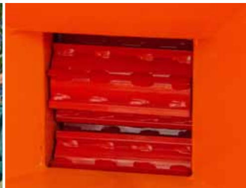
Rouleaux acheminant la matière vers le jeu de couteaux de déchiquetage
