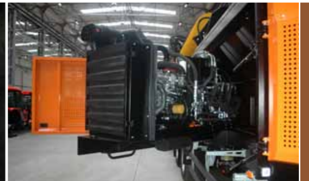
Le moteur et le système hydraulique sont montés sur un châssis basculant pour un accès rapide et facile pour les opérations de maintenance
