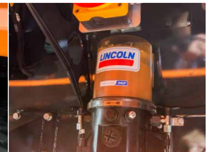
Système de lubrification centralisée Fournit une lubrification automatique de tous les composants clés de la machine.
