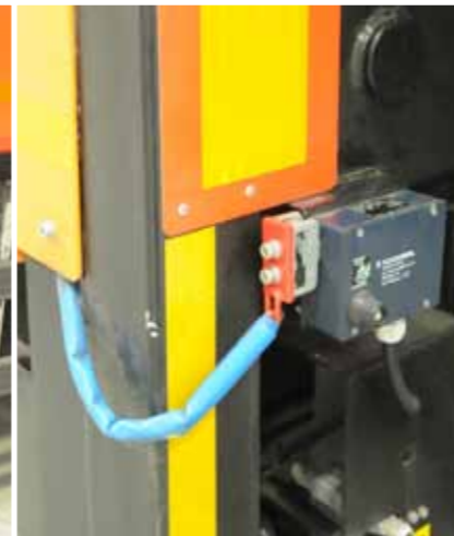
Sondes de sécurité montées sur les ouvrants latéraux qui coupent le moteur en cas d'ouverture
