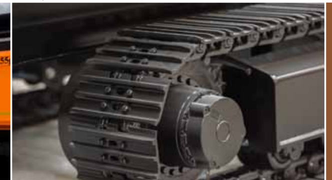
Les chenilles assurent à la machine une meilleure stabilité et facilitent son déplacement
