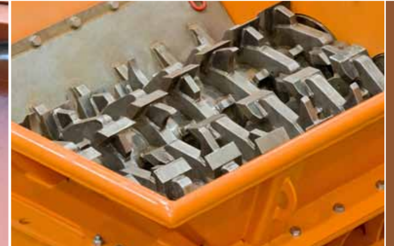
Rotors de différents types en fonction de la fraction souhaitée. Fabriquées en acier hardox par les leaders européens
