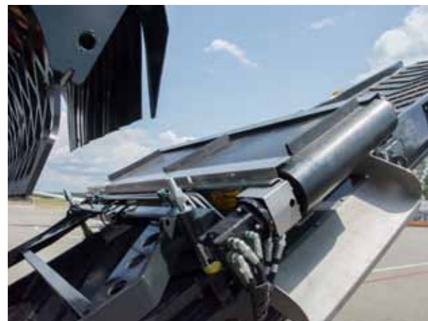
Séparateur magnétique L'utilisation d'un aimant au néodyme assure une séparation efficace des éléments ferromagnétiques du matériau.
