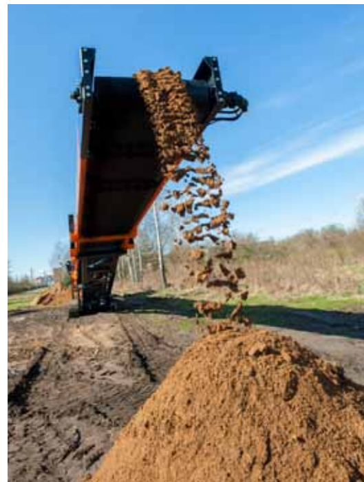
Le rouleau d'entraînement de la bande est particulièrement solide et résistant
