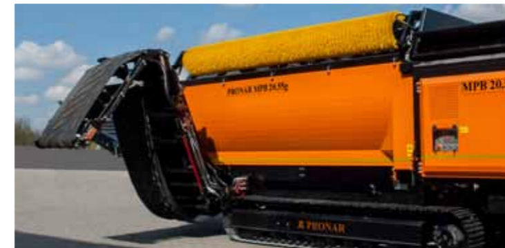
La bande de transport latérale se rabat sur le côté de la machine et réduit ainsi la hauteur pour le transport
