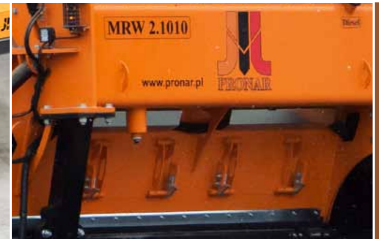
Ouvertures latérales 4x pour accéder rapidement et efficacement à la chambre de travail
