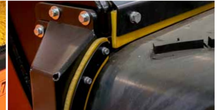
Isolation renforcée de la trémie pour éviter l'accumulation de matériau dans la zone interne de la machine
