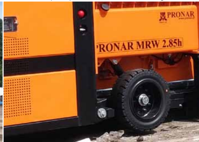
MRW 2.85h - Roues pour déplacer la machine sur chantier sans engin
