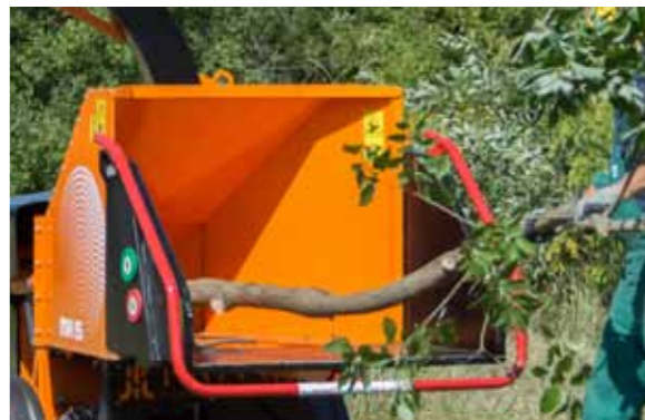
Les branches sont aspiré automatiquement au moyen de rouleaux d'alimentation à entraînement hydraulique
