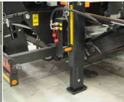
Les pieds hydrauliques assurent une stabilité accrue et un confort d'utilisation
