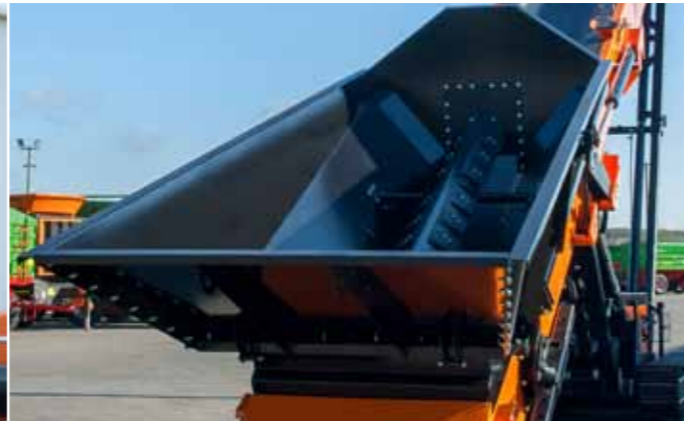
La poutre avec amortisseurs réglables soulage le tapis et élimine les charges dynamiques pendant le chargement
