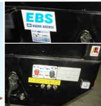
Système de freinage EBS et l'homologation européenne qui permet de tracter la machine sur voie publique jusqu'à 100km/h
