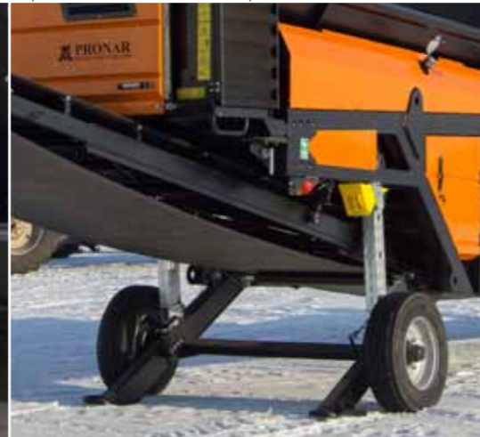
Bras de support arrière réglable hydrauliquement en position de travail ou de transport
