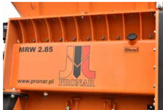
Chambre de broyage en acier hautement résistant Hardox
