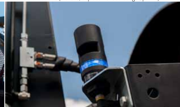
Lampe LED signalisatrice située en hauteur indique le mode de travail de la machine (marche, déplacement ou danger/panne)
