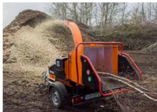
Rampe de chargement et barre de sécurité
