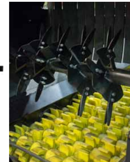
Fût à lames va répartir de manière homogène la matière à cribler
