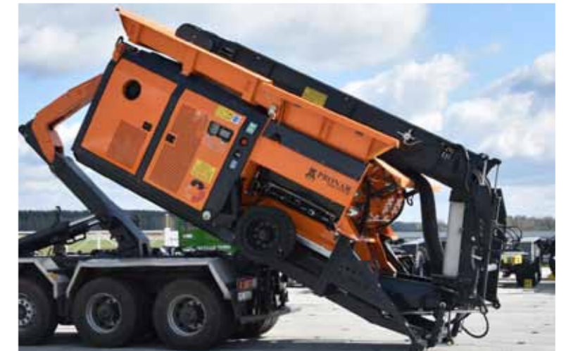
Version ampliroll. Machine conçue pour faciliter le transport sur un camion à trois essieux grâce à son faible poids (-16 000 kg)
