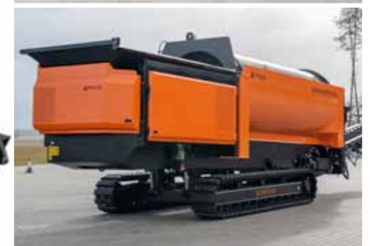
Le système hydraulique équipant le châssis de la machine MPB 20.55gh permet d'ajuster la hauteur et le niveau du crible pour faciliter le criblage et les déplacements sur terrains instables
