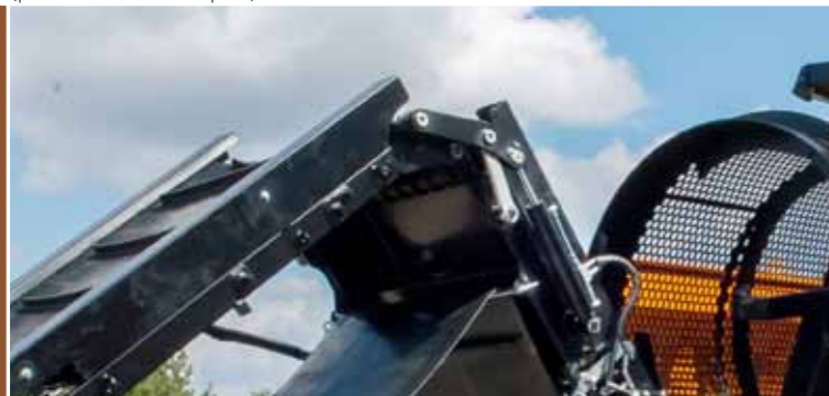
La bande de transport arrière est rabattue à l'aide de 4 pistons (pour faciliter le transport)
