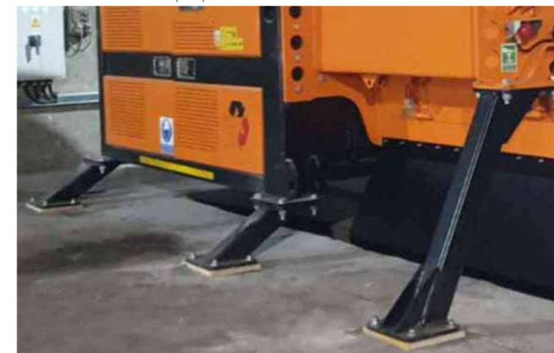
Pieds métalliques pour fixer la machine au sol
